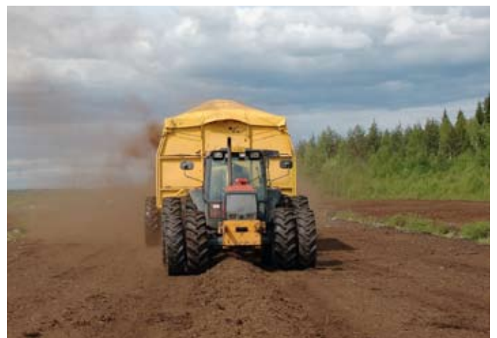
Mekaaninen kokoojavaunu turvesuolla. Kuva Vapo Oy.
